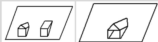
Dachaufbauten, Dacheinschnitte zurückversetzt: Giebellukarne / Schlepplukarne
